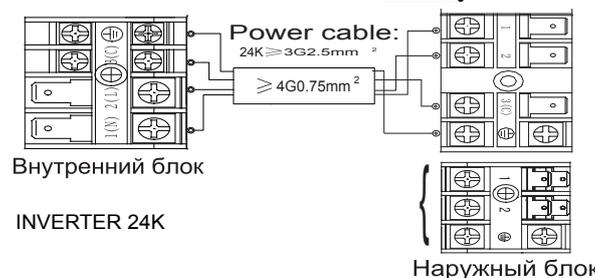
Для инверторных моделей используется кабель управления 4x1,5 мм<sup>2</sup>:
